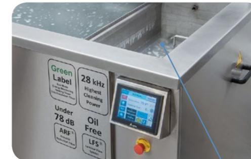
**Serbatoio di separazione dell'olio LFS** per una disoleazione facile e veloce di olio e grasso dalla vasca principale, mediante una pompa di ricircolo.
